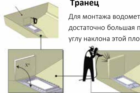
Для монтажа водомета в транец должна быть подготовлена достаточно большая площадка и соблюдено требование по углу наклона этой площадки в  $95^{\circ} \pm 10^{\circ}$  (или  $90^{\circ} \pm 10^{\circ}$ ) по отношению к плоскости дна (плоскости водозаборного блока). В этой подготовленной площадке вырезается достаточно большое отверстие, через которое водомет заводится/помещается в машинное отделение в корпусе судна.
